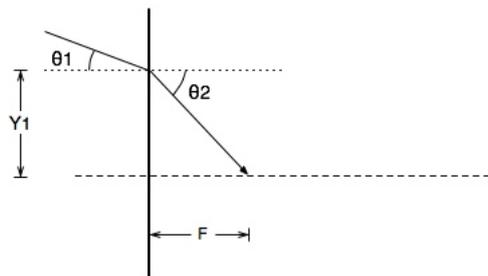
Für paraxiale Strahlen ( $y_0 \approx 0$ ) ist  $\sin \vartheta_1 \approx \tan \vartheta_1$  und  $\sin \vartheta_2 \approx \tan \vartheta_2$ . Somit ergibt sich der Abstand  $F$  des Schnittpunktes des Strahles zur Symmetrieachse (*Fokussierungspunkt*):
