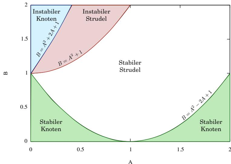
**Abbildung 0.4:** Fixpunkt-Typ im Brüsselator-Modell je nach  $A, B$ -Werte.
