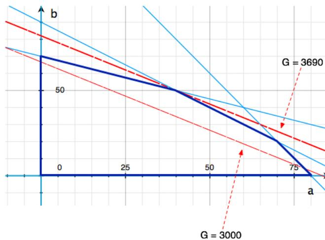
Zu finden ist die Gerade  $36a + 45b = G$  mit maximalem  $G$  die noch einen gemeinsamen Punkt mit dem zulässigen Gebiet hat. Aus der Graphik ist ersichtlich: der entsprechende  $a$ -Wert entspricht genau dem Schnittpunkt der Geraden  $3a + 6b = 420$ ,  $a + b = 90$ . Dieser ergibt sich durch einfaches Auflösen als  $a = 40$ . Dabei beträgt der Gewinn genau  $G = G(40, 90 - 40) = 3690$ .
