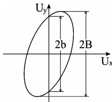
Bild 7: Bestimmung der Phasendifferenz  $\Delta\phi$  mit Hilfe von Lissajous - Figuren
