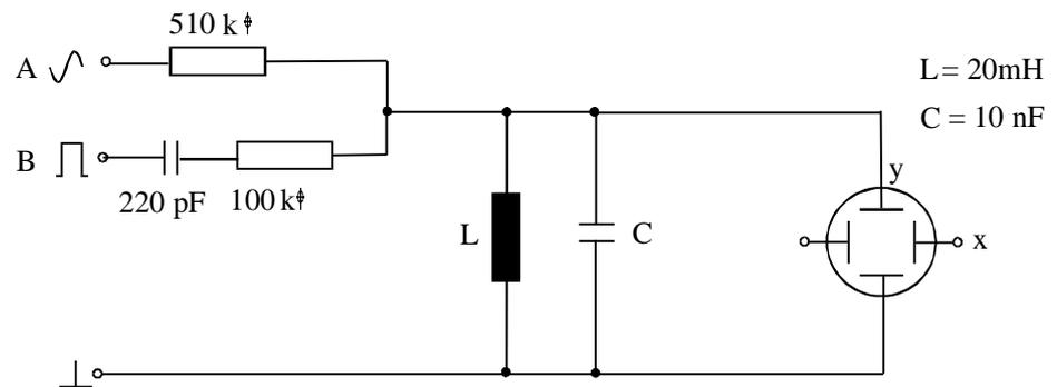
Bild 2: Schaltung zur Messung freier und erzwungener Schwingungen
