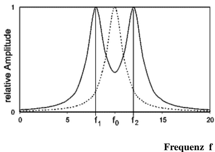
Bild 6: Resonanzfrequenzaufspaltung
