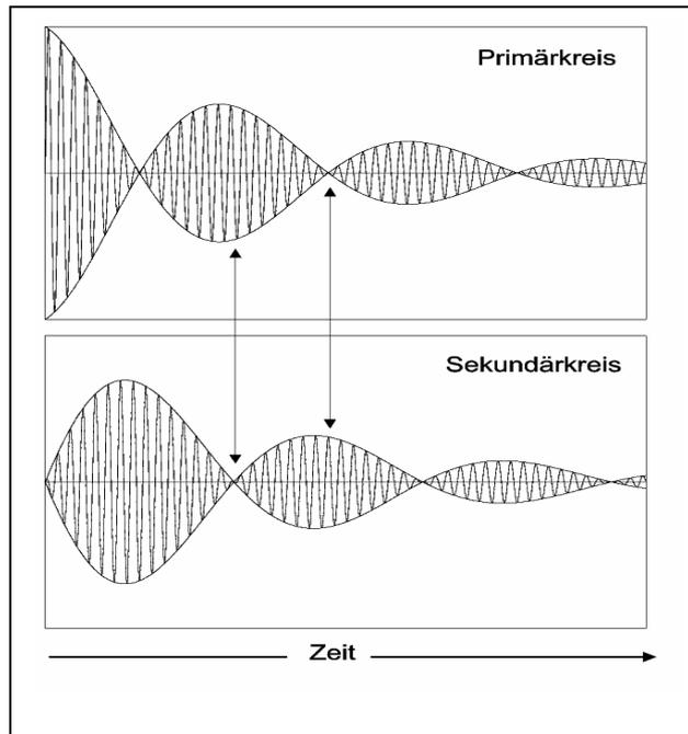
Bild 5: Freie Schwingungen gekoppelter Schwingkreise
