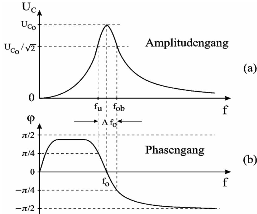
Bild 3: Amplituden- und Phasengang des Parallelschwingkreises
