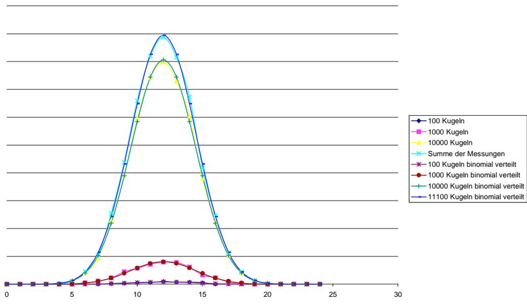
Abb. I.1: Die Kurven der Messergebnisse und theoretischen Voraussagen sind hier übereinandergelegt. Man erkennt deutlich, dass sich die Messungen in guter Näherung wie die Berechnungen verhalten. Somit kann man von binomial verteilten Messgrößen sprechen.
