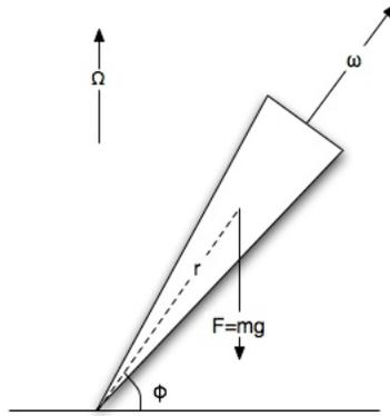
Die Schwerkraft  $\vec{F}_G = m\vec{g}$ , wobei  $m$  die Masse des Kreisels, bewirkt ein Drehmoment  $\vec{M} = \vec{r} \times \vec{F}_G$  senkrecht zur Achse  $\vec{r}$  und der Kraft  $\vec{F}_G$  in das Bild rein. Demzufolge ändert sich der Drehimpuls  $\vec{L} = J \cdot \vec{\omega}$  wie im folgenden Bild zu sehen ist:
