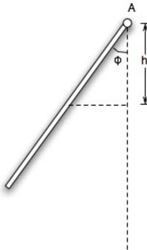
Beim Durchgang durch die Gleichgewichtslage befindet sich der Schwerpunkt im Abstand  $L/2$  vom Punkt A, was bedeutet das potentielle Energie des Stabes um  $\Delta E_p = mgL(1 - \cos(\phi))/2$  abgenommen hat. Diese hat sich jetzt in kinetische bzw. Rotationsenergie  $E_r = J\omega^2/2$  umgewandelt wobei  $\omega = v/L$  die Winkelgeschwindigkeit des Stabes um A ist. Also gilt:
