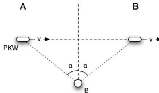
Sei  $v$  die gesuchte Geschwindigkeit. Für einen bestimmten Winkel  $\alpha$  ist die relativ-Geschwindigkeit  $v_r$  PKW-Beobachter gleich  $v_r = v \sin(\alpha)$ . Ist  $f$  die original-Frequenz des Motorgeräusches, so ist die Frequenz  $f'$  die der Beobachter misst gegeben durch
