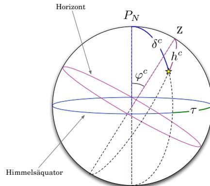
**Abbildung 0.2:** Zur Aufgabe 2.2: Transformation von Deklination  $\delta$  (Äquatorsystem) in Höhe  $h$  (Horizontsystem).
