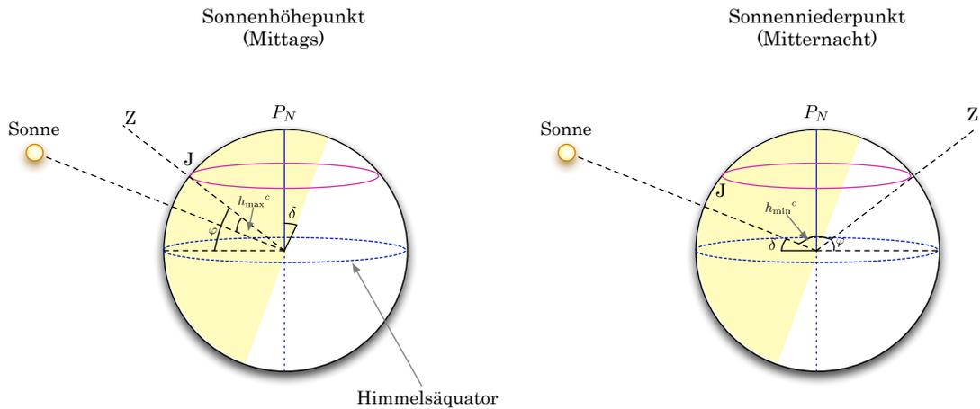
**Abbildung 0.6:** Zur Aufgabe 2.4: Maximale & minimale Sonnenhöhe bei einer Sonnendeklination  $\delta$ , beobachtet von einer geographischen Breite  $\varphi$  (Sommerzeit).
