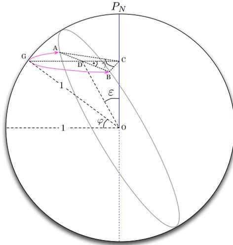
**Abbildung 0.9:** Zur Berechnung des Winkels  $\gamma$  (Tag-Dauer) am Ort  $G$  bei einer Ekliptikschiefe  $\varepsilon$ .
